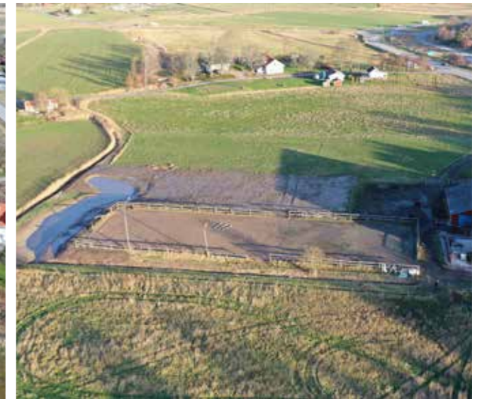
Efteråt. En damm har anlagts för att ge torrare hagor och minska näringsläckaget.
