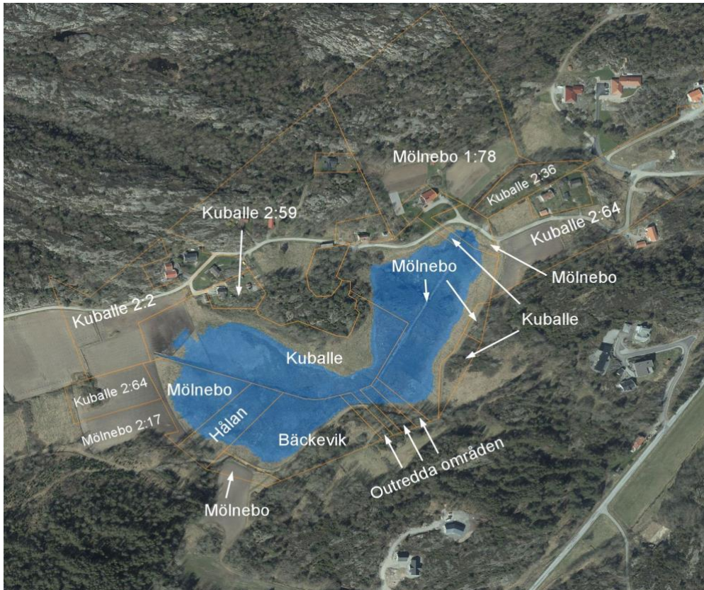
Figur 7 visar en översikt över befintliga fastigheter inom området. Blåmarkerad utgör planerad våtmark med dänningsnivå 34,7 m.
