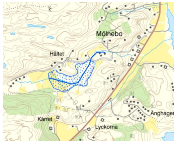
Figur 1 visar markavvattningsföretaget Mölnebo damm SF 1904. Den blå linjen representerar förrättningen (diket) och den blåprickade ytan visar våtmarksområdet.
